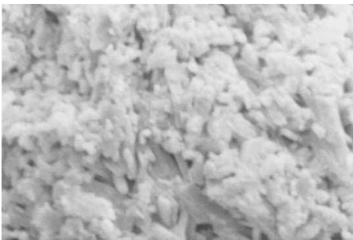
Рис. 2.12. Микроструктура прессованного гипсового камня негидратационного твердения в возрасте одного года (x2600)
