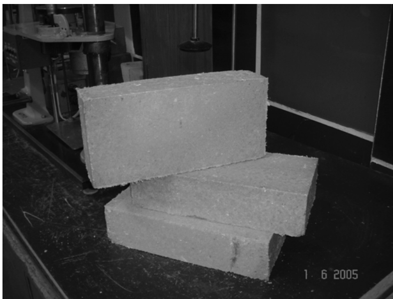
Рис. 4.22. Безобжиговый прессованный кирпич на основе гипсосодержащих отходов Конаковского фаянсового завода и опилок поперечной распиловки
