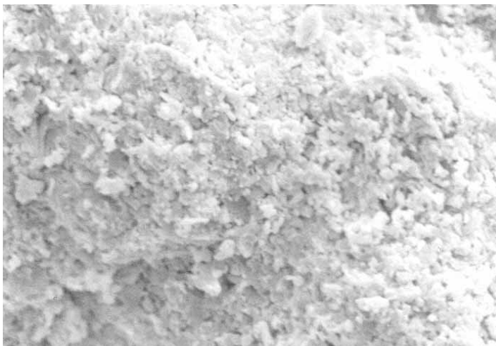
Рис. 2.11. Микроструктура прессованного гипсового камня негидратационного твердения в возрасте одного года (x1000)
