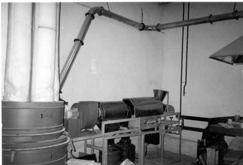
Рис. 4.5. Экспериментальная установка для тонкого измельчения минеральных порошков
