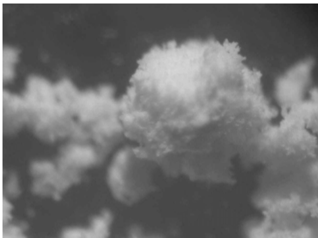
Рис. 3.14. Внутренняя микроструктура бинарной дисперсной системы на основе порошков дигидрата (x 84)
