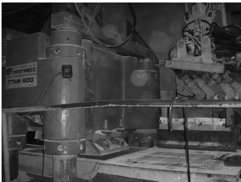
Рис. 4.21. Гибкий производственный модуль ГМК-600, используемый для получения безобжигового гипсового композита в условиях завода по производству силикатного кирпича
