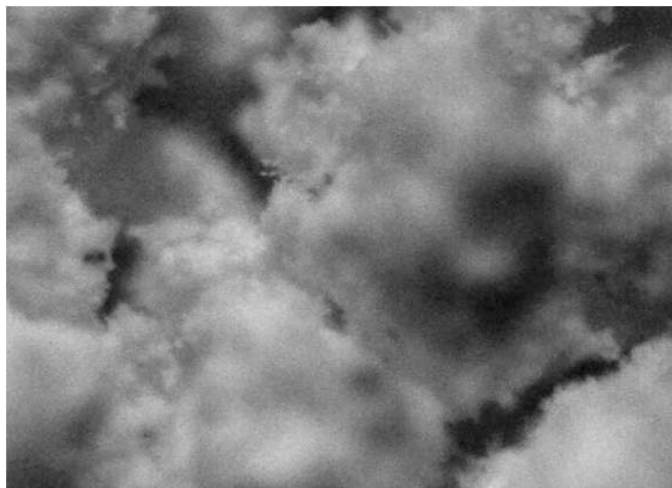
Рис. 3.15. Внутренняя микроструктура бинарной дисперсной системы на основе порошков дигидрата (x 200)
