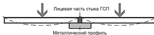
Рис. 2. Прогиб ГСП в ограждающей конструкции
