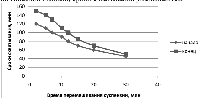
Рисунок 4. Сроки схватывания в зависимости от длительности перемешивания гипсового теста.
