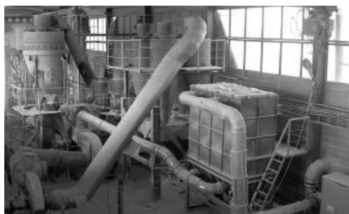
Рис.5 Измельчительно-классифицирующий комплекс для производства тонкодисперсного мела на базе дезинтегратора ДЗ-10 и центробежных классификаторов КЦС-10 и КЦД-20.
