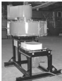
Рис.2. Центробежные классификаторы КЦС-10 и КЦД-5.
