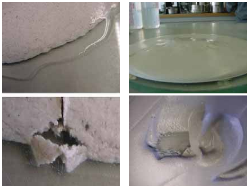
Рис. 7. Раствор кальцинированного фосфогипса а) без применения турбосмесителя б) с применением турбосмесителя
