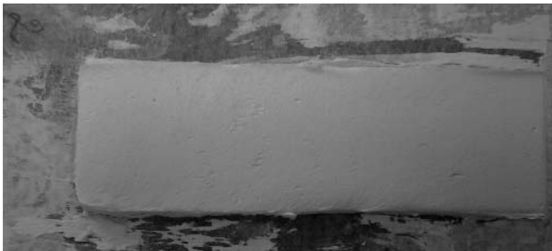
Рисунок 4. Клиновой тест на трещиностойкость гипсовой шпатлёвки с полиолом Sitren PSR 100.
