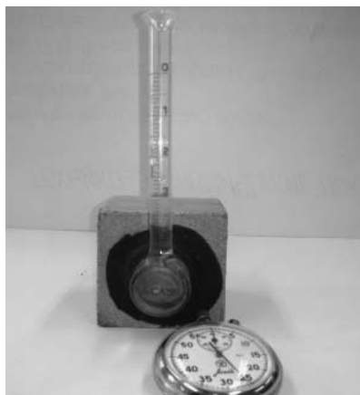
Рисунок 2. Проверка эффективности гидрофобизации поверхности с помощью трубки Карстена
