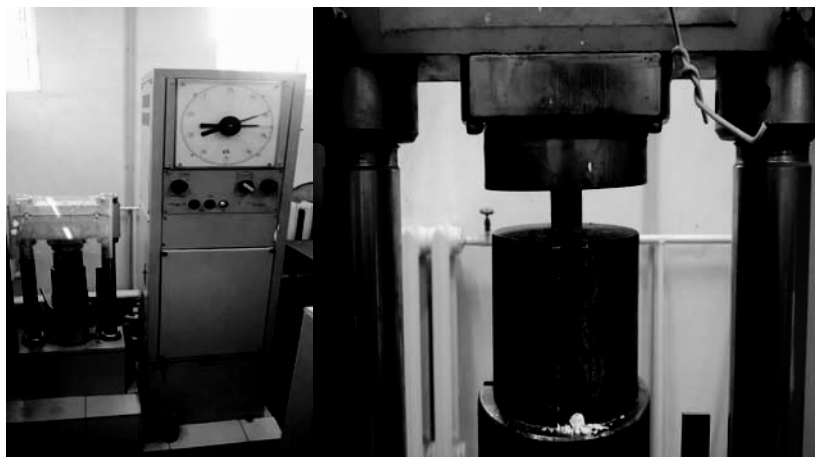
Рисунок 1. Проведение испытаний гипсовых образцов на сжатие
