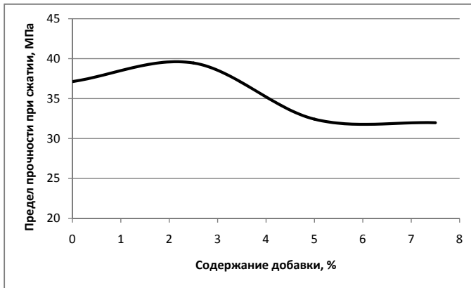
Рисунок 2. Влияние пенокерамического наполнителя Kerwood на прочность самоармированных композитов
