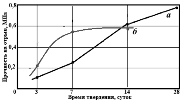
Рисунок 2. Динамика нарастания прочности штукатурного покрытия во времени: а – на основе портландцемента; б – на основе гипсового вяжущего
