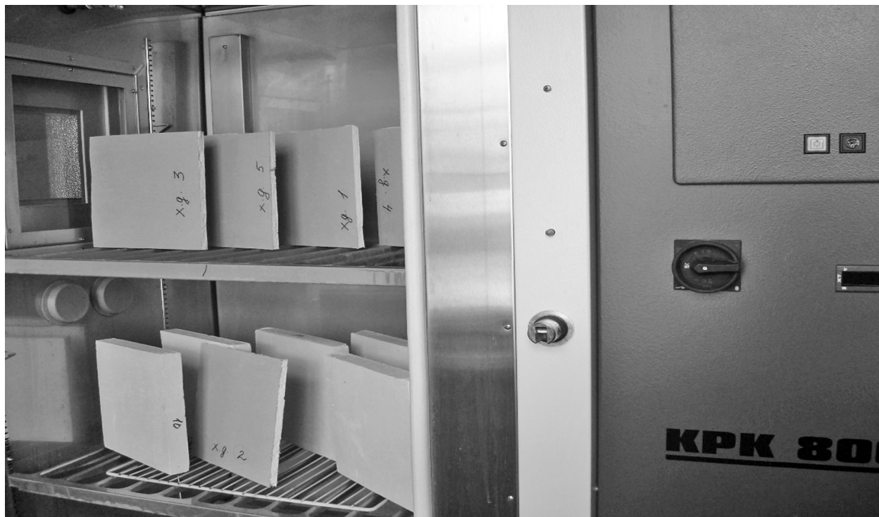
Рисунок 2. Фрагмент климатической камеры (определение сорбционной влажности при \phi=75\% образцов гипсовой сухой смеси и гипсокартона)
