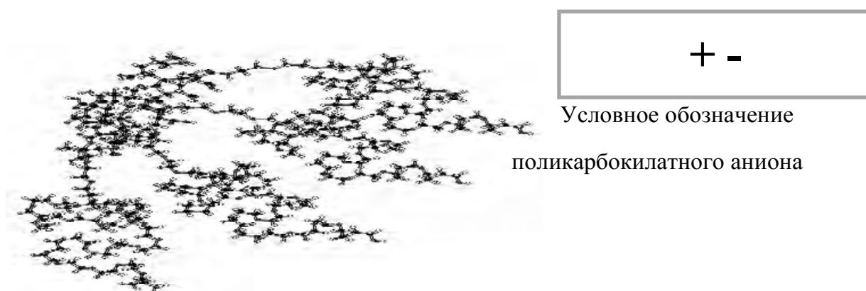
Рис. 5. Поликарбоксилат натрия размеры около 100 Ангстрем (10 мкм). Гипсовые частицы 1-6,3 \cdot 10^{-3} мм, или 1-6 мкм, 1000-6000 Ангстрем
